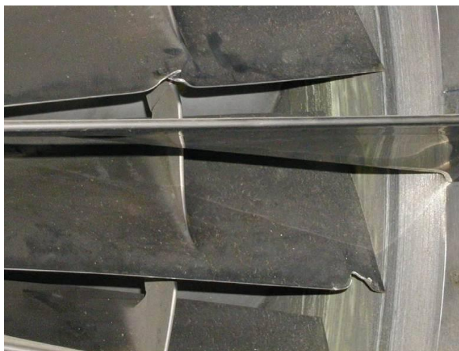
Рис.2. Дефекты лопаток компрессора ГТД [5]
