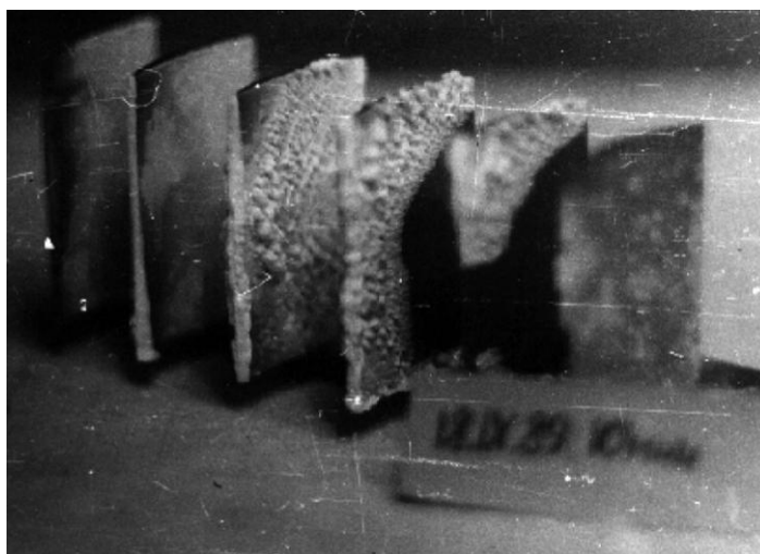
Рис.3. Загрязнение лопаток ГТД солью [6]
