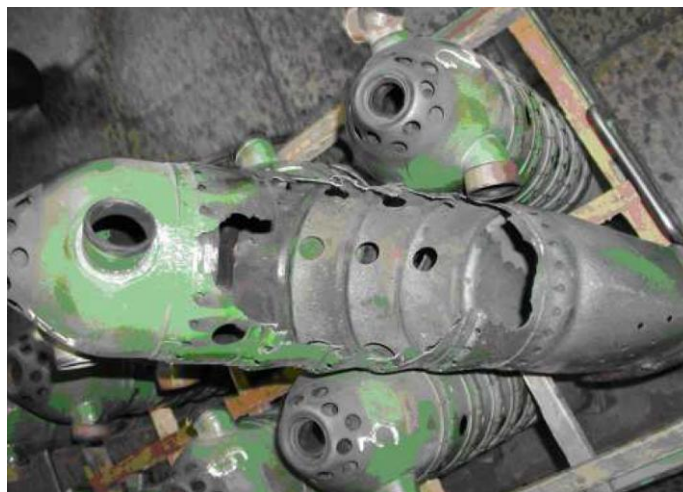
Рис.4. Прогар жаровой трубы [3]
